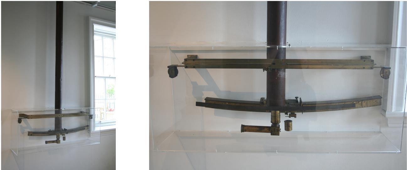
FIGURE 32 – Secteur zénithal (télescope pointant au zénith, permettant la mesure de la distance zénithale des étoiles). Conçu pour James Bradley, il est installé à l’observatoire de Greenwich. C’est avec cet instrument que J. Bradley découvrit l’aberration de la lumière et la nutation de l’axe terrestre (photos LLG).
