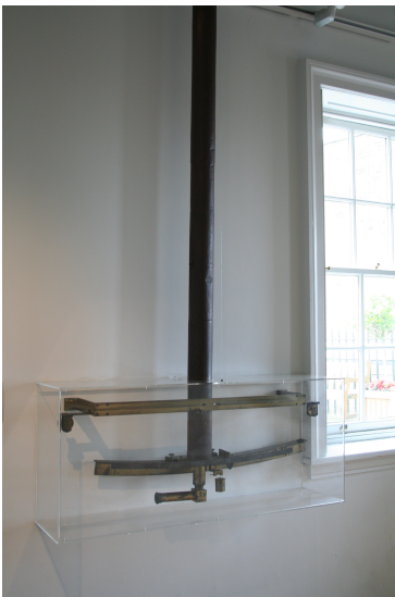
FIGURE 46 – Secteur zénithal (téléscope pointant au zénith, permettant la mesure de la distance zénithale des étoiles). Conçu pour James Bradley, il est installé à l'observatoire de Greenwich. C'est avec cet instrument que J. Bradley découvrit l'aberration de la lumière et la nutation de l'axe terrestre (photos L. Le Guillou).
