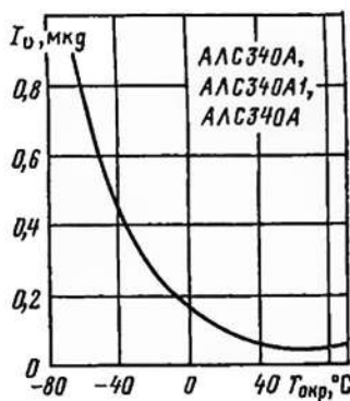
Типовая зависимость силы света от температуры окружающей среды
